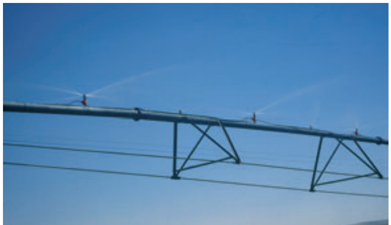
Pivote central: Torre central, conducción portaemisores y sistema de alineamiento por biela.
