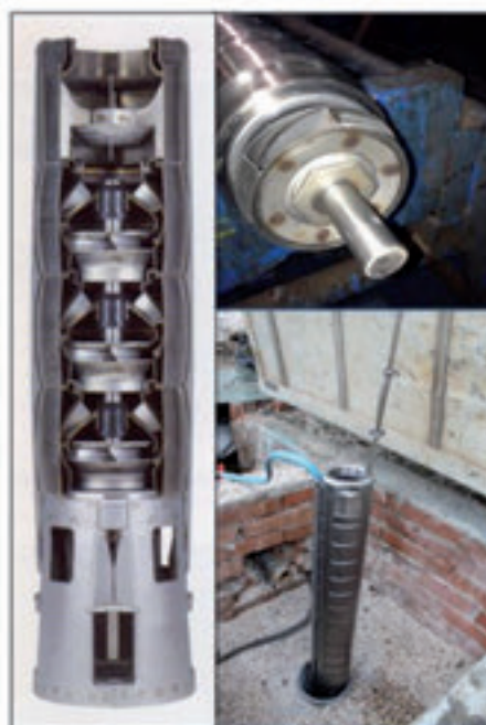
Distintos tipos de bomba en función de los materiales empleados en su fabricación. De izquierda a derecha: INDAR, WATEX+ y Bomba de chapa.
