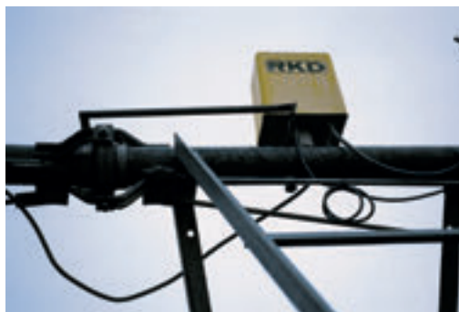
Pivote central: Torre central, conducción portaemisores y sistema de alineamiento por biela.
