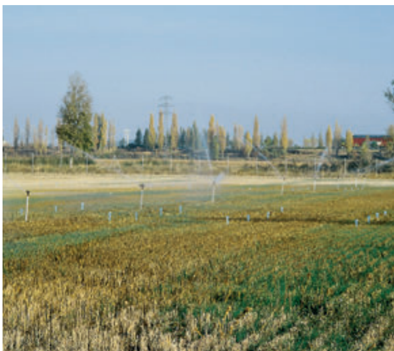
Red de pluviómetros para evaluar la uniformidad en una cobertura total
