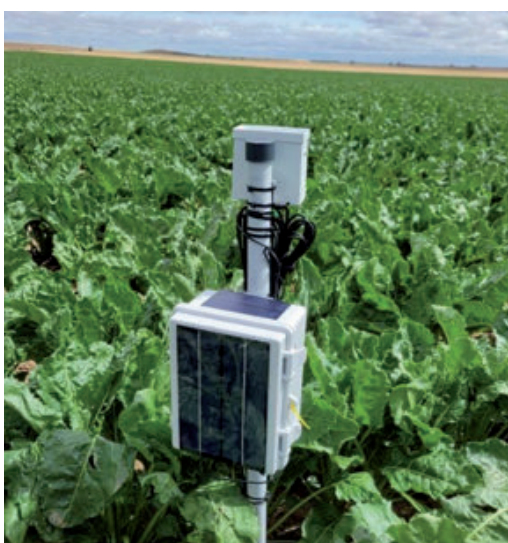
Izqda.: sensor de humedad de suelo, en el momento de su instalación, antes de taparlo para devolver el terreno a su estado inicial. Dcha.: Imagen de un registrador de datos (datalogger) y un pluviómetro instalado en uno de los demostradores utilizados en el proyecto EFFIREM.
