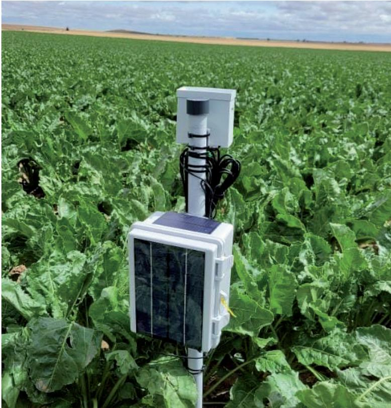
**FIGURA 1.** Imagen de un registrador de datos (datalogger) y un pluviómetro instalado en uno de los demostradores utilizados en el proyecto EFFIREM. En la página anterior, un sensor de humedad de suelo, en el momento de su instalación, antes de taparlo para devolver el terreno a su estado inicial.
