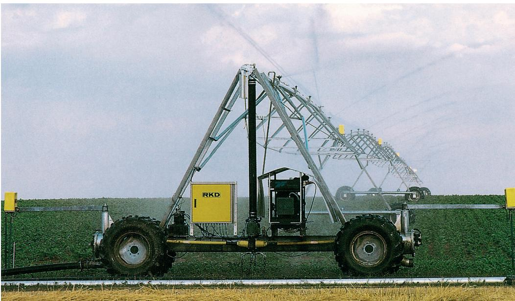
Ejemplo de diferentes áreas regadas mediante un pivote lateral multidireccional
