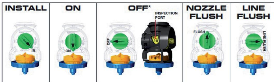
En esta tabla se muestran las funciones de la boquilla 3NV de Nelson: **INSTALL**: Posición para insertar la boquilla; **ON**: Posición en la que el aspersor está abierto; **OFF**: El aspersor está cerrado. Permite también revisar si la boquilla está sucia/obstruida; **NOZZLE FLUSH**: Limpieza de la boquilla; **LINE FLUSH**: Posición que permite limpiar la suciedad existente en el bajante, proveniente de la tubería.
