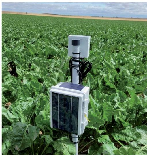
Izqda.: sensor de humedad de suelo, en el momento de su instalación, antes de tapanlo para devolver el terreno a su estado inicial. Dcha.: Imagen de un registrador de datos (datalogger) y un pluviómetro instalado en uno de los demostradores utilizados en el proyecto EFFIREM.
