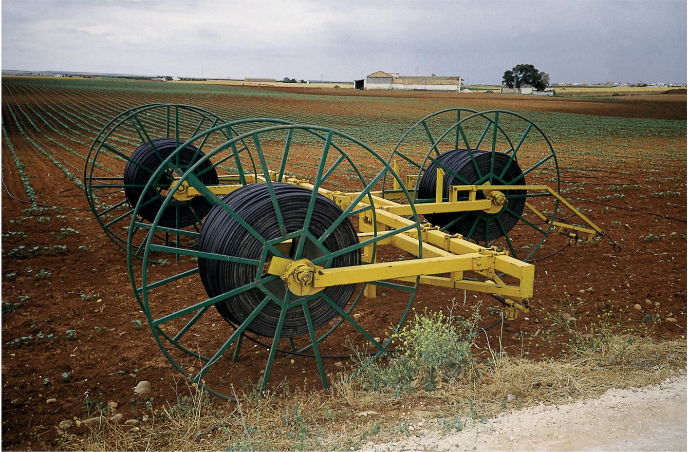
Sistema enrollador de tubería para riego por goteo.
