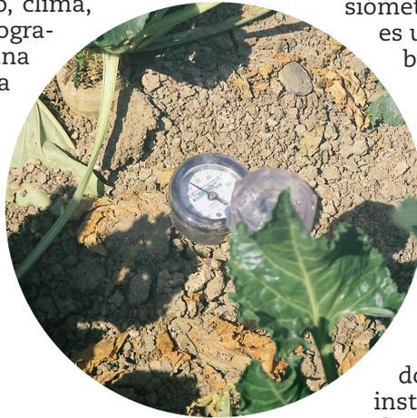
es un método práctico basado en la medida de la tensión con que el agua es retenida por el suelo; su rango de medida es de 0 a 0'8 bar. Estudios en remolacha revelan que el momento óptimo del riego se produce cuando el tensiómetro, instalado a 30 cm de profundidad, alcanza el valor de 45 cb (J.M. Arroyo, comunicación personal, 2000).
