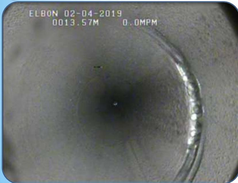
**Desgaste de la tubería de revestimiento por el roce de las bridas de la tubería de impulsión por desviación del sondeo.**
