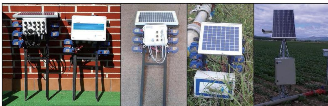
Imagen 12: Programadores GPRS de distintas marcas montados para trabajar con tuberías portátiles de aluminio. Fuente elaboración propia.
